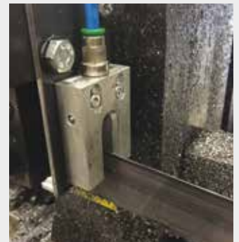
CENTRALINE DI LUBRIFICAZIONE MINIMALE PER SEGATRICI MINIMAL LUBRICATION UNITS FOR SAWING MACHINES МАЛОРАСХОДНЫЕ СМАЗОЧНЫЕ АГРЕГАТЫ ДЛЯ ПИЛЬНЫХ СТАНКОВ MINIMALMENGSCHMIERAGGREGATE FÜR SÄGEMASCHINEN
