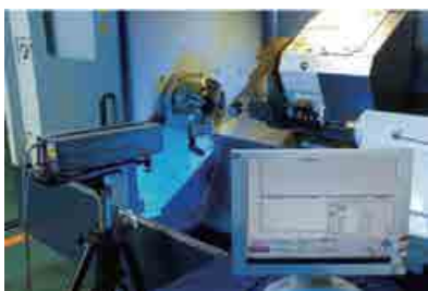
Лазерная калибровка на современном оборудовании
