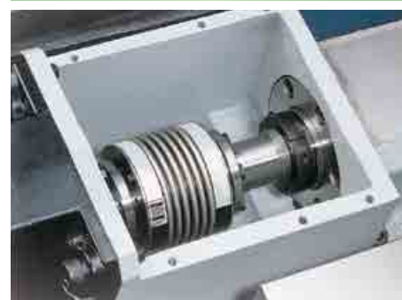
Эластичные соединительные элементы дают гарантию плавности и точности осевого движения
