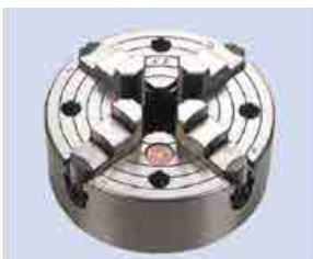
4х-кулачковый патрон с независимыми кулачками
