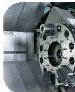
Револьверная голова VDI с вращающимся инструментом (опция)
