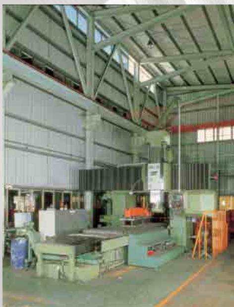
Многоцелевой станок для обработки деталей с пяти сторон, произведенный в Японии фирмой MARUFUKU
