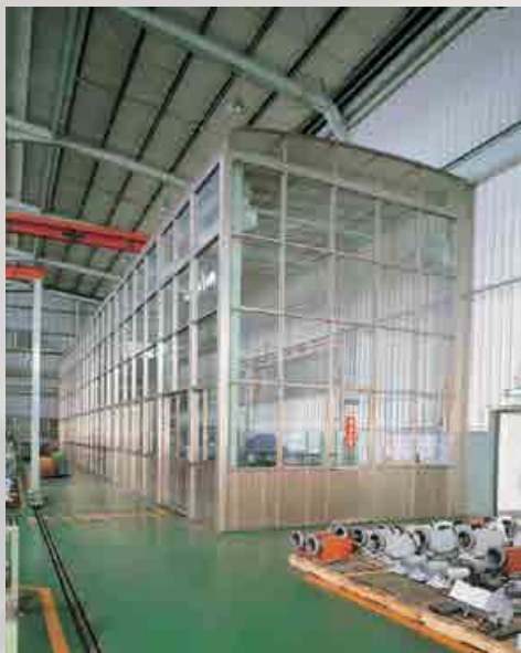
Наш цех по сборке шпинделей имеет внутри постоянную температуру и защищен от попадания пыли
