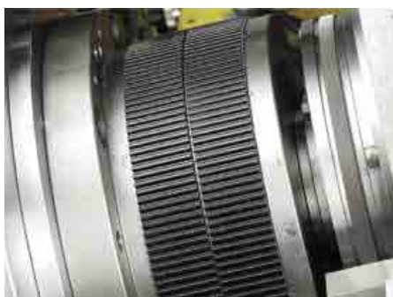
Кодировщик высокого разрешения оси С (опция)
