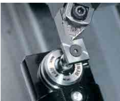
Контактный датчик для настройки инструмента (опция)
