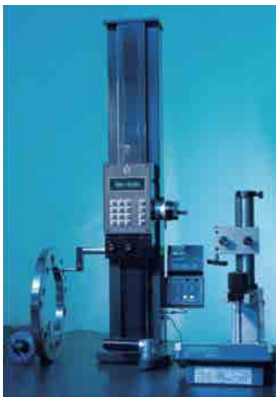
Измерение деталей двумерным измерительным прибором
